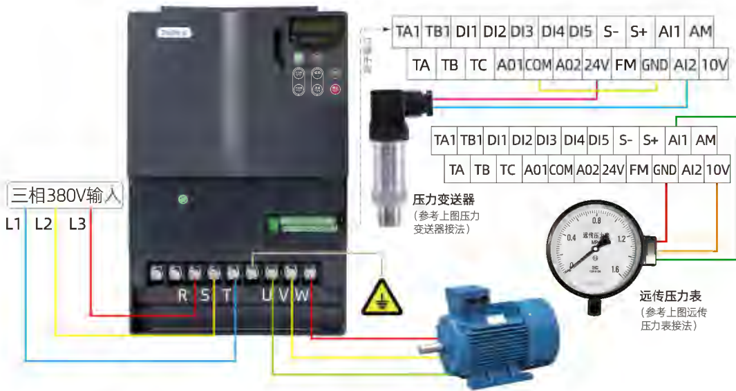
三相380V变频器接线图
